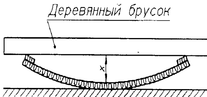
Рисунок Б.3 - Измерение отклонения от плоскостности плиты
